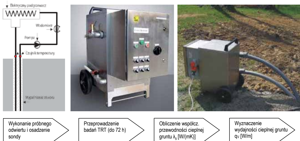
Rys. 15.1. Schemat oraz widok urządzenia pomiarowego TRT (źródło TRT Pomiar)
