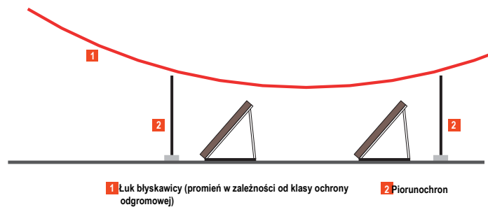
Rys. 2.9. Tyczki przejmujące uderzenie pioruna muszą być tak wysokie, aby łuk błyskawicy nie dosięgał kolektorów (źródło Viessmann [15])
