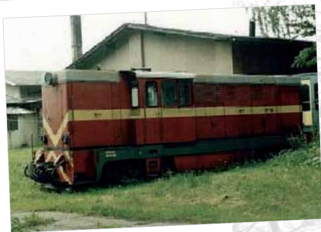
Lokomotywa spalinowa Lxd2-464 (silnik Maybach) Białogard 1981-83, Koszalin 1978-81 i 1983-2005, rok produkcji: 1978.
